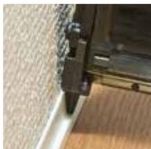
La posición rediseñada del tornillo permite disparar muy cerca de la pared.
